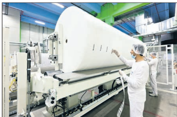
Auf großen Rollen wird der Vliesstoff bei Sandler zur Auslieferung fertig gemacht. Foto: Sandler
